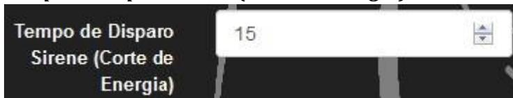
A opção **Tempo de Disparo Sirene (Corte e Energia)** possibilita a programação para funcionamento de 01 (um) a 20 (vinte) minutos quando ocorre um corte de energia.
